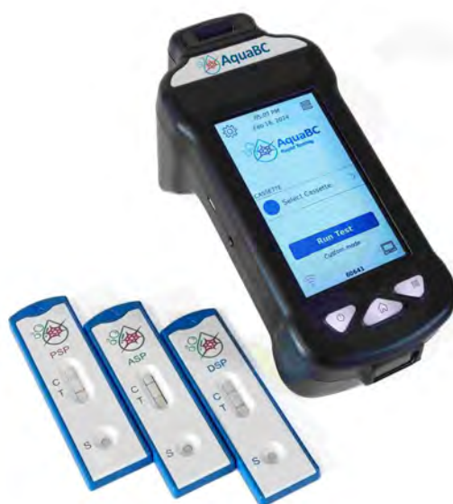
Imagen 6: Tests rápidos para detección de Veneno Paralizante de Mariscos (VPM/PSP), Veneno Amnésico de Mariscos (VAM/ASP) y Veneno Diarreico de Mariscos (VDM/DSP), y lector portátil de AquaBC Rapid Testing
