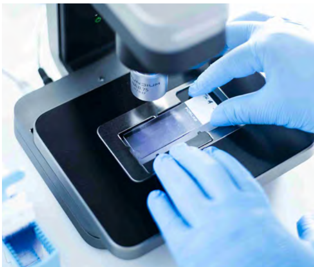
Imagen 1: Vetscan Imagystr® digitalizando frotis de sangre.
