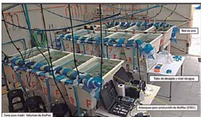
Figura 2. Diseño general del sistema de cultivo para la producción de Biofloc, en 12 unidades de estanques de 250 L. Foto Laboratorio de Cultivo Masivo de Crustáceos (CMC) de la Universidad Católica del Norte.
