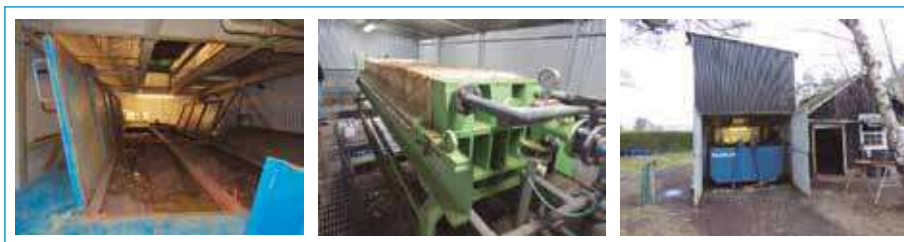
Figura 2: Filtro prensa y estanque acumulador de una piscicultura.
