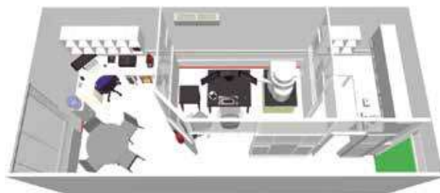
Figura 2. Plano del Laboratorio de Microscopía Avanzada (LMA-ULagos) habilitado en el Pabellón Riñihue del Campus Chuyaca, Osorno. Incluye el área del SEM-EDS y la sala de preparación de muestras con un secador de punto crítico y un metalizador/grafitador.
