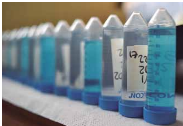
Figura 8: Muestras de agua en distintos periodos para análisis de Absorbancia o Densidad Óptica.
