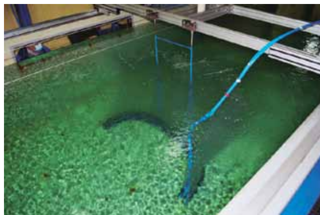
Figura 6: Difusores montados en carro de arrastre.
