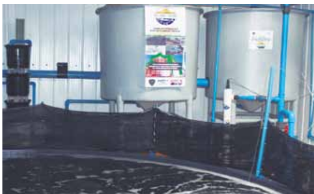
Figura N°1 equipos de la estación modular de acuicultura EMA solar, para el tratamiento integral del agua.
