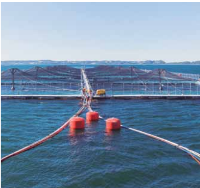
Figura 4: Sistema de distribución de piensos a un tren de jaulas. Centro Pilpilehue. Gentileza de Salmones Camanchaca S.A.
