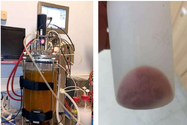
Figura 2: Bioreactor con un cultivo de *B. subtilis* productor de astaxantina (izquierda). Biomasa concentrada de *B. subtilis* rica en astaxantina (derecha).
