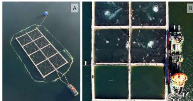
Figura 4: Mecanismos de mitigación utilizados durante la floración de *Heterosigma akashiwo* de 2024. A) Cortina de burbujas; B) Aireación por surgencia.
