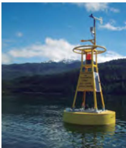
**Figura 2.** Boya oceanográfica y meteorológica instalada en canal Puyuhuapi, Región de Aysén. Programa COPAS Sur-Austral.
