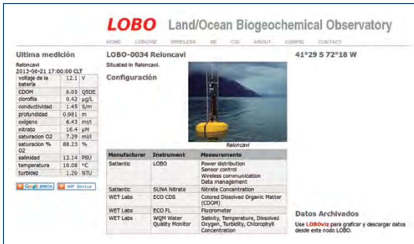
Figura 5. Despliegue de plataforma web con visualización de datos en línea, registrados y transmitidos desde la plataforma de observación oceanográfica instalada en el estero Reloncaví, Región de Los Lagos (imagen proporcionada por Dr. Carlos Moffat, investigador del programa COPAS Sur-Austral y director del proyecto FONDEQUIP AIC-45).
