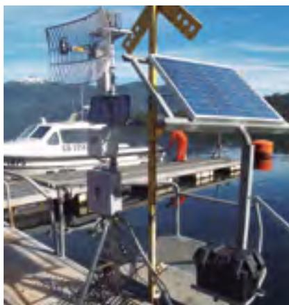
**Figura 3.** Estación oceanográfica instalada en un centro de cultivo de la Región de Aysén (foto: gentileza Dr. Iván Pérez, investigador del Programa COPAS Sur-Austral y del Proyecto INNOVA de CORFO, liderado por el CIEP).
