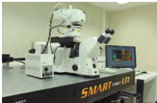
Microscopio Confocal Espectral/Dos Fotonos LSM780 Zeiss.
