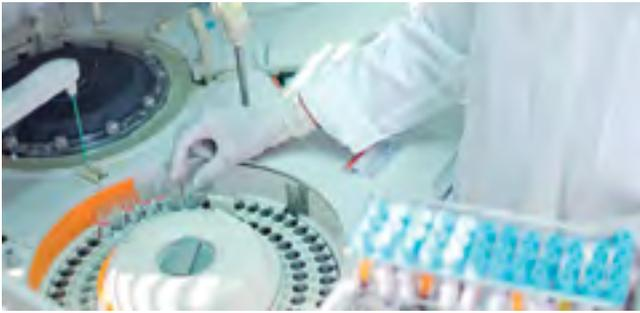
**Figura 4.** Bandeja de reacción y bandeja de reactivos para muestras de plasma en equipo autoanalizador clínico.
