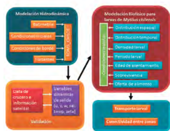
Figura 3: Sistema de modelación biofísica larvas de Mytilus chilensis . Modelo hidrodinámico ROMS validado acoplado a modelo biofísico.
