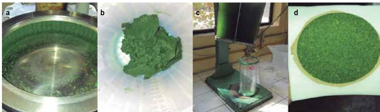
**Figura 2.** Producción de papel de acuerdo normas TAPPI. De izquierda a derecha: a) Pulpa refinada por molino, b) Pulpa obtenida, c) Estandarización en medio acuoso para la obtención de fracciones y d) Hoja húmeda recién formada.
