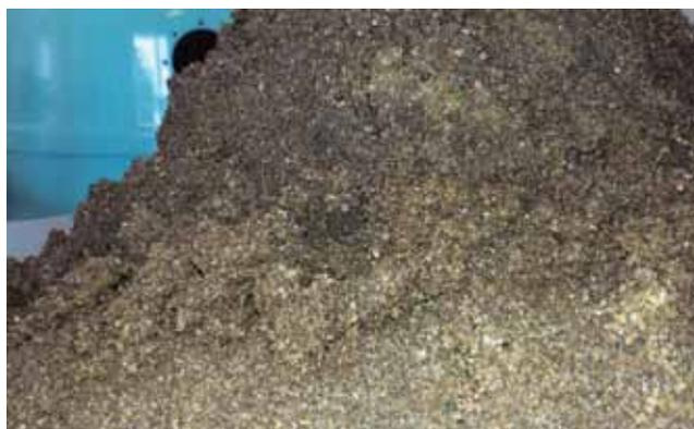
Imagen 4. Carga filtrante saturada de biofilm.
