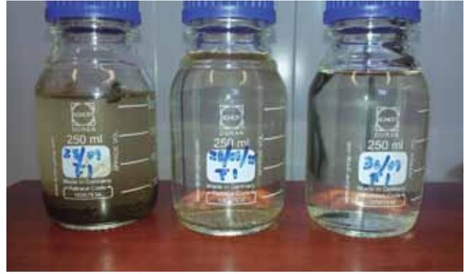
Imagén 6. Capacidad de retención por floculación en 48 hrs.
