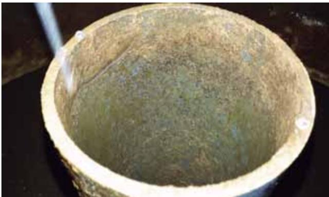
Imagen 1. Vástago Difusor con Biofilm colesterol hidráulico.
