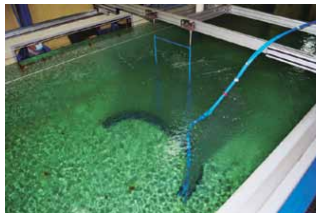
Figura 6: Difusores montados en carro de arrastre.
