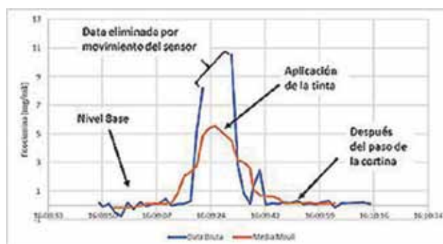
Figura 11: Curvas obtenidas por el BAS, siendo la azul datos brutos y se eliminan valores cuando se movió el sensor del agua, debido al paso de la estructura que sujeta la cortina en el canal; y curva naranja corresponde a media móvil.
