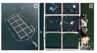
Figura 4: Mecanismos de mitigación utilizados durante la floración de *Heterosigma akashiwo* de 2024. A) Cortina de burbujas; B) Aireación por surgencia.
